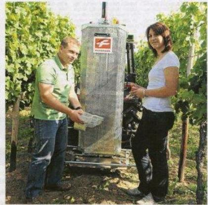
Frank Melling und Kathrin Wind führen das Gerät vor, das Bodenproben aus 30, 60 und 90 Zentimeter Tiefe zutage fördert.
